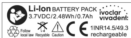
Tenga en cuenta que las baterías de polímero de litio pueden reaccionar, produciéndose una explosión, un incendio o vapores, si se manipulan de forma inadecuada o se dañan mecánicamente. Las baterías de polímero de litio dañadas no deben volver a utilizarse.
