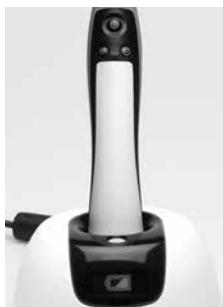
La batterie est un consommable et doit, de ce fait, être remplacée environ tous les 2,5 ans, cycle de vie d'une batterie. Voir l'âge de la batterie sur l'étiquette.
