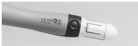
Coloque la pieza de mano con suavidad en el apoyo correspondiente en la base de carga sin aplicar ninguna fuerza. Si se utiliza una funda higiénica, quitela antes de cargar la batería. Si es posible, utilice siempre la lámpara con la batería totalmente cargada; esto prolongará su vida útil. Por ello, se recomienda colocar la pieza de mano en la base de carga después de cada paciente. Si la batería está totalmente descargada, el tiempo de carga es de 2 horas.
