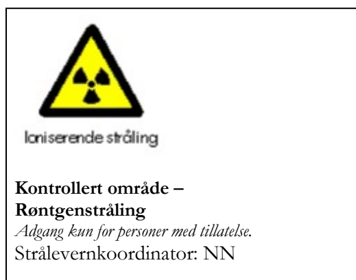
Figur 6.2: Eksempel på merking av kontrollert område.
