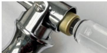
Insérer d'abord l'ampoule, puis visser l'aiguille d'injection.
