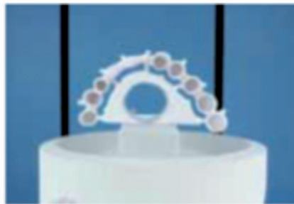
Posizionamento corretto sul vassoio di sinterizzazione
